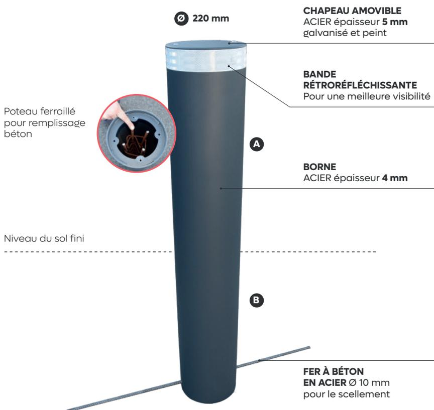
Poteau ferrailé pour remplissage béton
